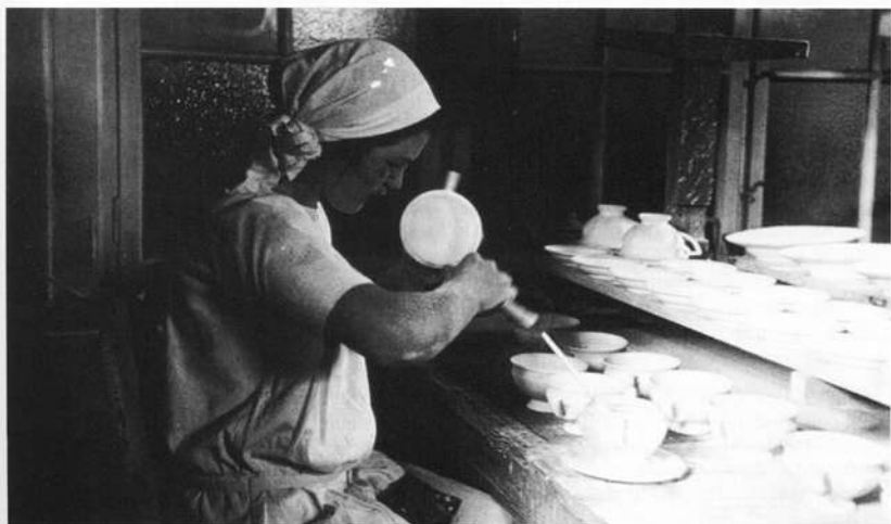
Verputzerei, Porzellanfabrik Rosenthal, Selb 1930
