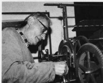
Rund 200 Stunden braucht Robert Dürr, um eine mechanische Turmuhr zu reparieren.
