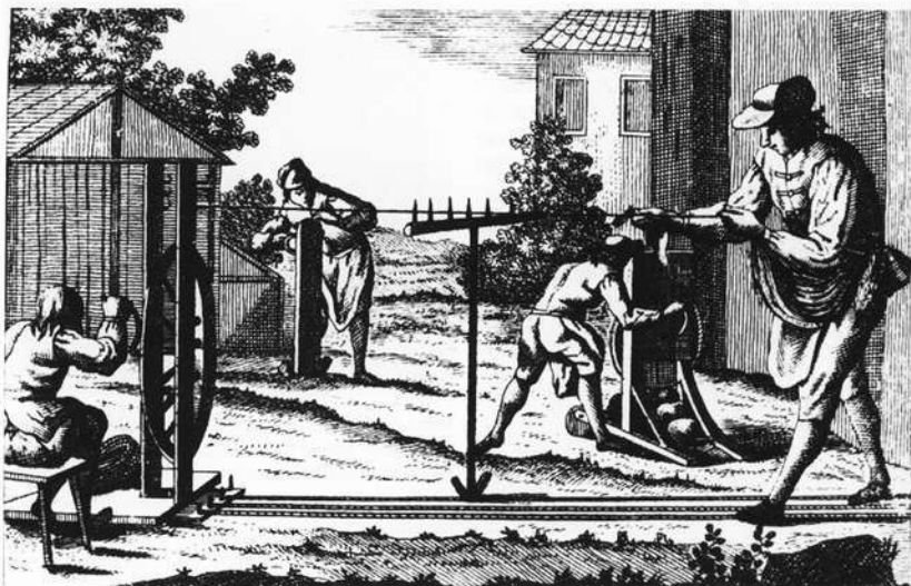
Abb. 3: Eine Seilerbahn nach Johann Amos Comenius, 1654. In der Bildmitte eine Stütze, in: Orbis sensualium pictus, 1. Auflage. Reproduktion: Rheinisches Freilichtmuseum – Landesmuseum für Volkskunde in Mechernich-Kommern
