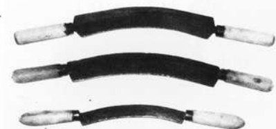
Abb. 2: Drei Haareisen aus dem Weißgerbermuseum in Doberlug-Kirchhain in der Niederlausitz. Die Längen der drei Werkzeuge betragen von oben 61,0 cm, 61,5 cm und 53,0 cm. Foto: Azzola
