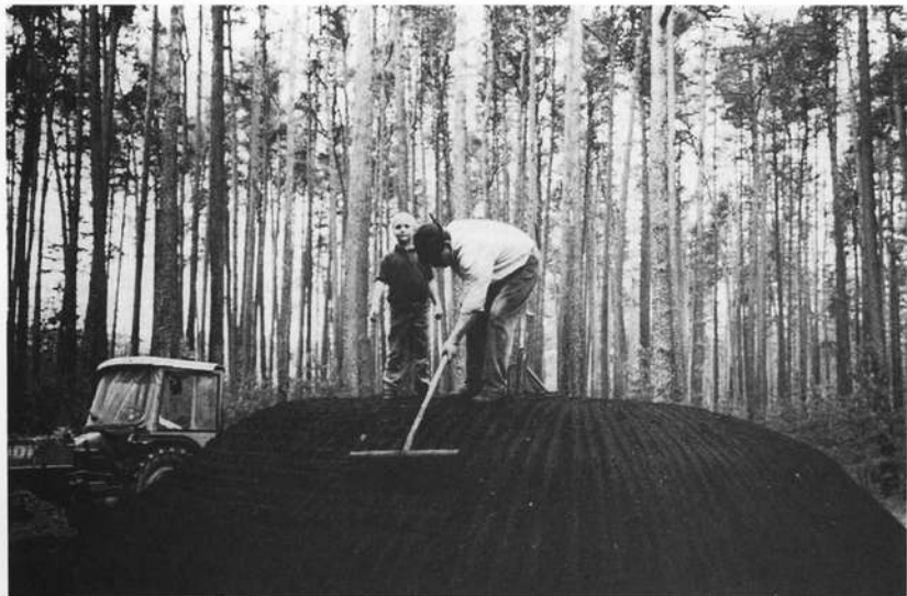
Hans Kübler mit Sohn bei der horizontalen Verfestigung der Kohlerde durch das Andrücken der „Schloa“
