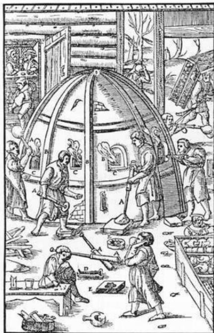
Abb. 6. Die Verarbeitung des Glases am Werkoen. Nach Agricola: De re metallica, 1556.
